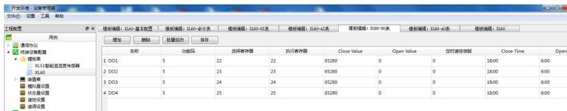
第五步，编辑“DI表”，“DI表”为开关量的状态表，因为此XL60有4个DI，所以需要增加4个DI，再加4个DO的状态，4个DO的状态统一在“DI表”体现，所以在编辑“DI表”时，需要建立4个DI状态和4个DO状态。点击“增加”如下图，读取状态用01功能码，因为只有8个开关量状态，通过01功能码去读取DI和DO的状态，返回命令数据为1个字节（高8位字节），返回的数据是按位来解析的。所以这里的寄存器地址，只要全部填写DI1的寄存器就可以，bit位从8开始一直到15。对应DI1-DI4,D01-D04的状态。SOE类型按默认就可以。然后点击保存。
