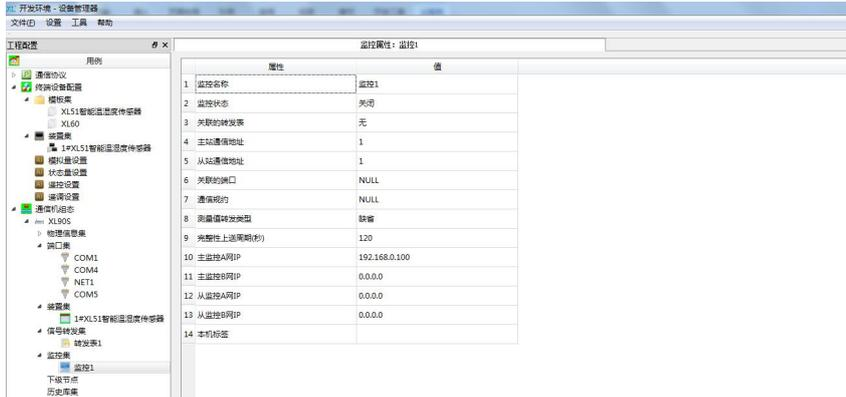
XL90 工程配置做完后，需要下载到 XL90 里面，选中“物料信息集”，展开“物料信息集”如下图一，选中“主机”出现如下图二，以太网 IP: 输入 XL90 网关 IP (ETH0 的 IP)，然后在连接密码处输入 888888，点击连接，出现下图三，连接状态为“ON”说明连接成功
