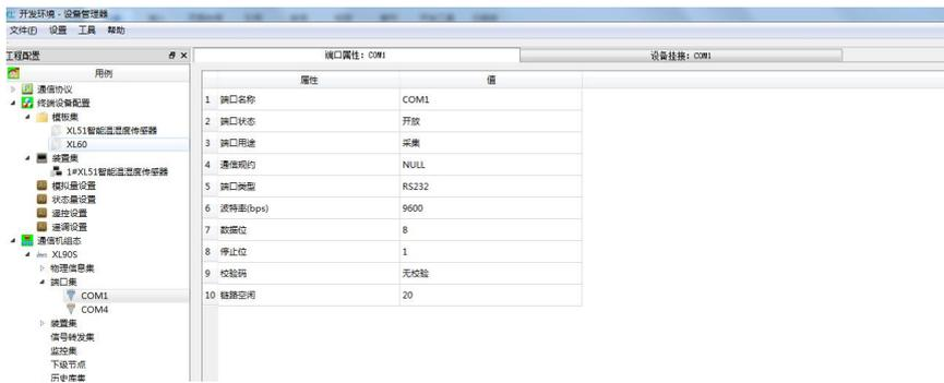
3、如果 XL90 对上是通以以太网口交互数据，那需要建立 NET 端口，选中“端口集”点击右键选择“新建 NET 端口”出现下图一，NET 名称可以自己命名，这里按默认 NET1，点击确认，出现如下图二，端口状态：开放，端口用途：转发，通信规约：Modbus 协议从站 v1.0.0.0，网络协议：TCP，端口：可以根据自己实际情况填写，这里默认 9125。如果是 MQTT 协议或者 redis 协议可以在通信规约选择对应的协议，MQTT 一般默认端口为 1883，redis 可以根据 redis 服务器那边来确定是多少。网络协议按默认，不需要设置。
