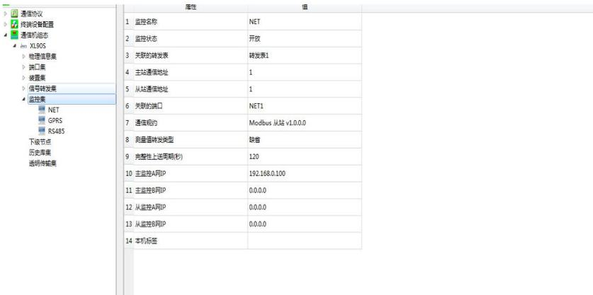
5、配置完“监控集”主监控 A 网 IP 后，展开“物理信息集”--“主机”如下图一，在以太网 IP 处输入 XL90 的 ETH0 的 IP 地址，如果你修改了 XL90 的 IP 地址，那输入你修改过的，没有修改过，XL90 网关的 IP 地址在网关的背面或者侧面。然后输入密码“888888”，只需要输入以太网 IP 和密码，其他不要输入。点击连接，连接状态“ON”后依次点击“生成配置”-----“下载配置”-----“重启装置”。配置主监控 A 网 IP 设备成功，就可以使用。上位机可以跟网关通过以太网口建立链接，如果是 modbus-tcp 命令读取网关的数据，网关做服务器端，上位机做客户端。网关服务端口在网关背面或者侧面。网关默认的设备地址为 1。支持 03 功能码读取数据。网关寄存器表，可以展开“信号转发表”，如下图二。里面寄存器地址就是网关对应采集下面设备的寄存器地址，设备名称就是对应在 XL90 工程里面建立的采集设备名称，数据对象名称就是表明什么数据。
