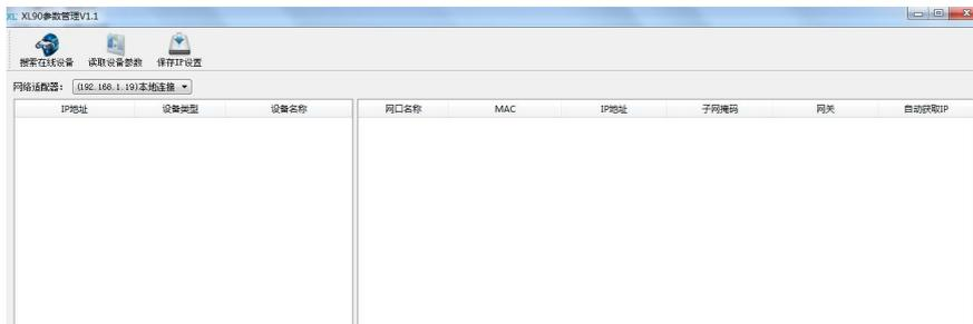
3、点击“在线搜索设备”，如果 XL90 网关跟电脑网线连接没问题会出现如下图，在软件的左侧会搜索到网关的 IP。
