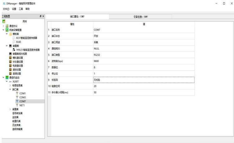
3、如果 XL80 对上是通过以太网口交互数据，那需要建立 NET 端口，选中“端口集”点击右键选择“新建 NET 端口”出现下图一，NET 名称可以自己命名，这里按默认 NET1，点击确认，出现如下图二，端口状态：开放，端口用途：转发，通信规约：Modbus 协议从站 v1.0.0.0，网络协议：TCP，端口：可以根据自己实际情况填写，这里默认 9125。如果是 MQTT 协议或者 redis 协议可以在通信规约选择对应的协议，MQTT 一般默认端口为 1883，redis 可以根据 redis 服务器那边来确定是多少。网络协议按默认，不需要设置。
