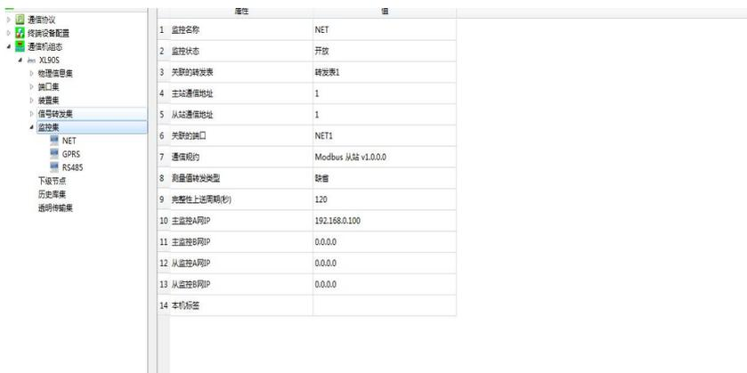
5、配置完“监控集”主监控 A 网 IP 后，展开“物理信息集”--“主机”如下图一，在以太网 IP 处输入 XL80 的 ETH0 的 IP 地址，如果你修改了 XL80 的 IP 地址，那输入你修改过的，没有修改过，XL80 智能主机的 IP 地址在智能主机的背面或者侧面。然后输入密码“888888”，只需要输入以太网 IP 和密码，其他不要输入。点击连接，连接状态“ON”后依次点击“生成配置”-----“下载配置”-----“重启装置”。配置主监控 A 网 IP 设备成功，就可以使用。上位机可以跟智能主机通过以太网口建立链接，如果是 modbus-tcp 命令读取智能主机的数据，智能主机做服务器端，上位机做客户端。智能主机服务端口在智能主机背面或者侧面。智能主机默认的设备地址为 1。支持 03 功能码读取数据。智能主机寄存器表，可以展开“信号转发表”，如下图二。里面寄存器地址就是智能主机对应采集下面设备的寄存器地址，设备名称就是对应 XL80 工程里面建立的采集设备名称，数据对象名称就是表明什么数据。
