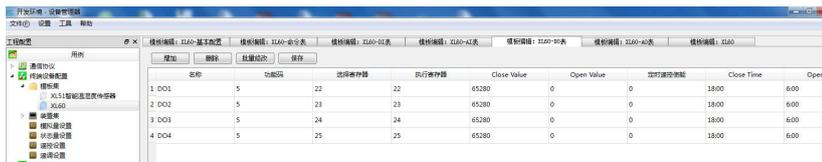
第五步，编辑“DI表”，“DI表”为开关量的状态表，因为此XL60有4个DI，所以需要增加4个DI，再加4个DO的状态，4个DO的状态统一在“DI表”体现，所以在编辑“DI表”时，需要建立4个DI状态和4个DO状态。点击“增加”如下图，读取状态用01功能码，因为只有8个开关量状态，通过01功能码去读取DI和DO的状态，返回命令数据为1个字节（高8位字节），返回的数据是按位来解析的。所以这里的寄存器地址，只要全部填写DI1的寄存器就可以，bit位从8开始一直到15。对应DI1-DI4,D01-D04的状态。SOE类型按默认就可以。然后点击保存。
