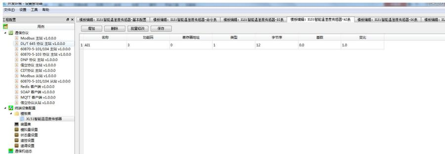
参数设置说明：名称：模拟量名称，可以根据实际的模拟量名称取名，功能码：modbus 协议读取命令的功能码，我们公司读取模拟量的功能码为 03 功能码，有一些客户的产品是 04 功能码。寄存器地址：模拟量在设备里面对应的寄存器地址（填写用 10 进制填写），字节序：根据模拟量返回的数据是什么字节序来定，我们公司产品的模拟量基本都是 16 位，字节序为 12。如果是 32 位的数据类型，字节序为 1234。每一家产品都有自己数据的字节序定义。按实际情况而定。类型：为模拟量的数据类型：1 代表 UINT，2 代表 INT，3 代表 FLOAT，4 代表 BCD，5 代表 ASCII。基数和变比按默认。基数为 0，变比为 1，设置好后点击保存。比如：建立 XL51 智能温湿度传感器的模拟量，如下图
