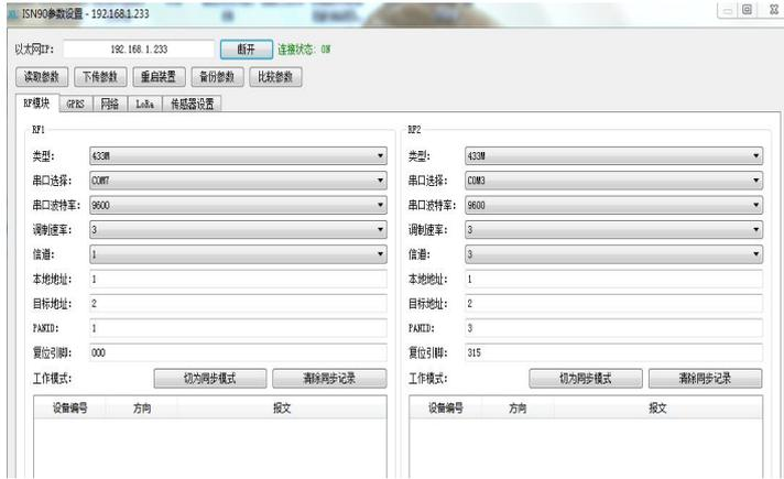
智能主机支持单射频模块工作，如果是 433MHZ（新 lora 模块），490MHZ，2.4G 在“RF 模块”里面设置参数。
